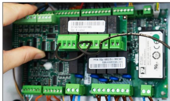
4. Die Zusatzplatine auf der CTS602 Platine montieren.
